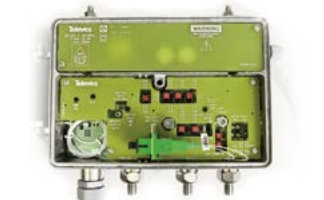
▲ Nodo Intemperie 232 x 140 x 90 mm
